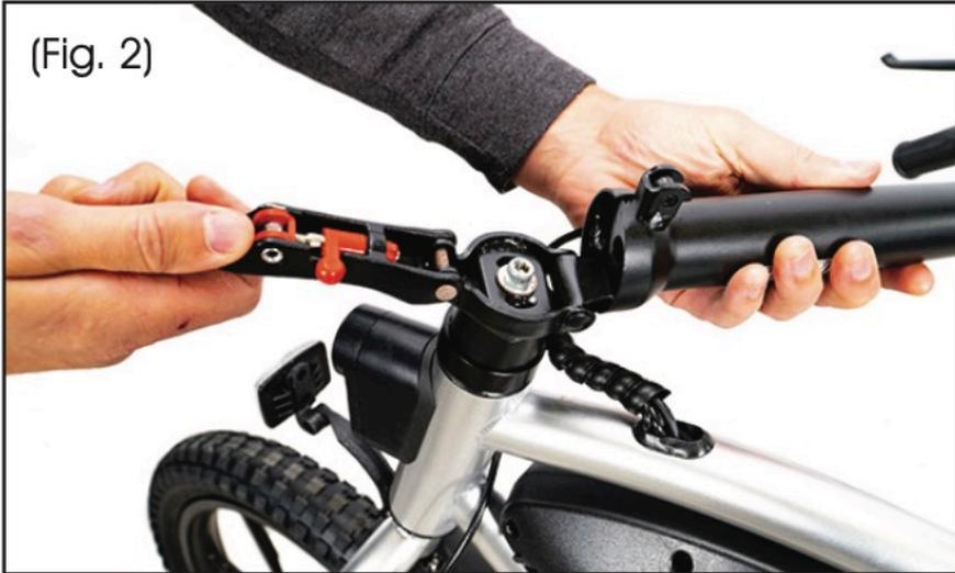
Une fois le guidon fixé, déverrouillez l'assemblage de la potence et repliez-le pour exposer le boulon intérieur.
